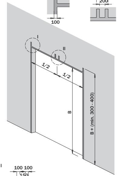
**CZ Varianta pro montáž 2 pružin (do šířky vrat 4 250mm, max. váhy 200kg)**
