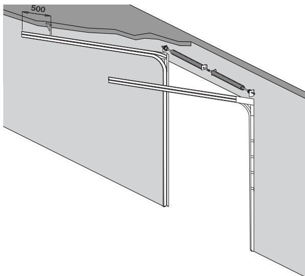
**CZ** Nad výšku vrat 3 010mm nebo plochy vrat větší jak  $12$  do  $20\text{ m}^2$ , je potřeba min. dvou horizontálních ukotvení u každé kolejnice.
