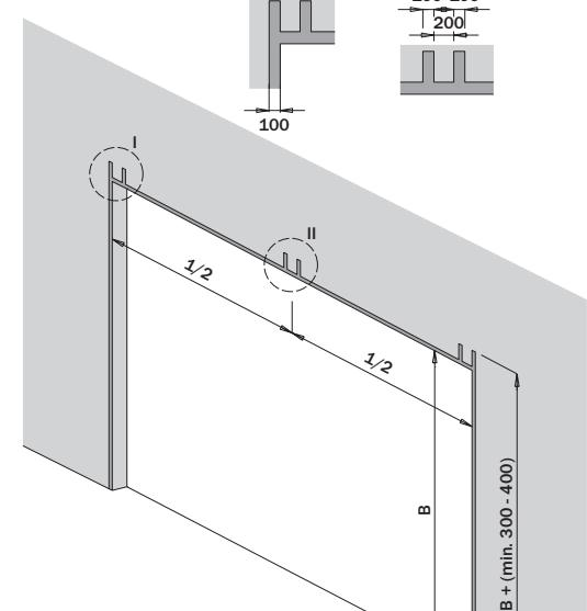
**CZ Varianta pro montáž 4 pružin (od šířky vrat 4 251mm, max. váhy vrat 200kg)**
